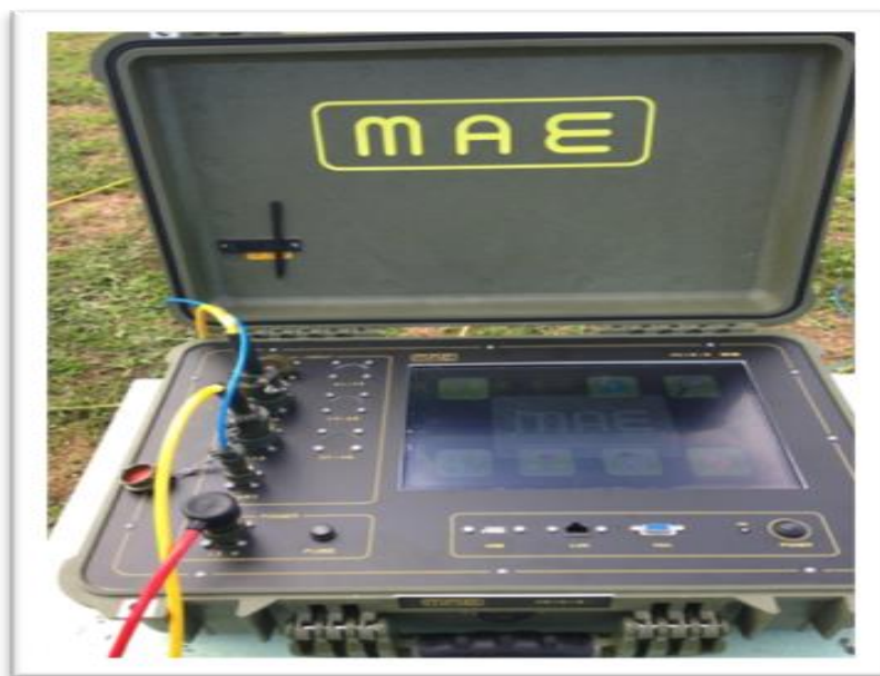
Figura 1 e 2 – Sismografo X 610 S della MAE e stendimento per sismica a rifrazione
